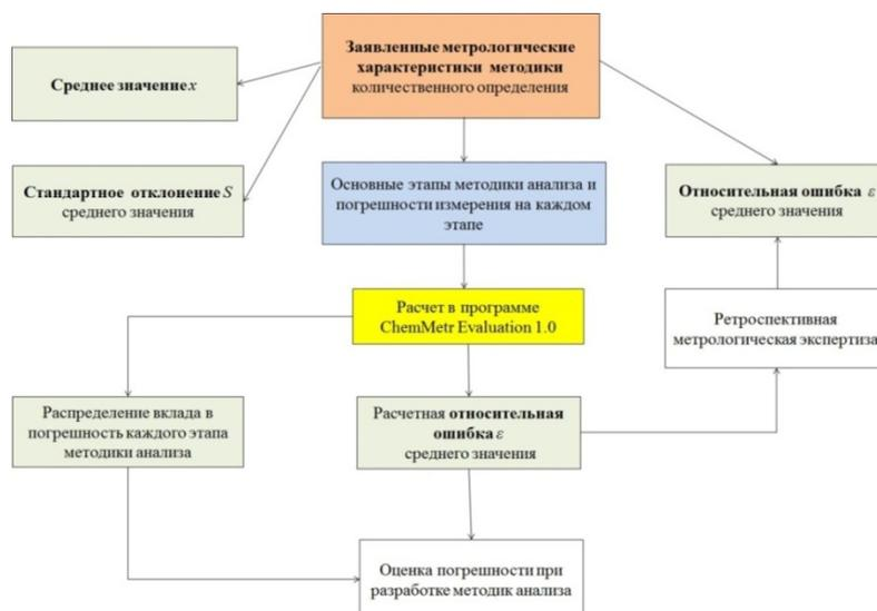
Рисунок 6 – Алгоритм применения компьютерной программы «ChemMetr Evaluation 1.0» в судебно-химической экспертизе и фармацевтическом анализе
