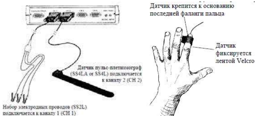
Рис. 3.1. Схема подключения оборудования и расположения датчика пульс-плетизмографа
