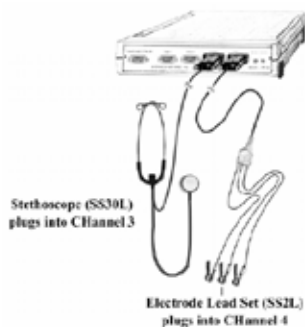
Рис. 2.2. Схема подключения оборудования
