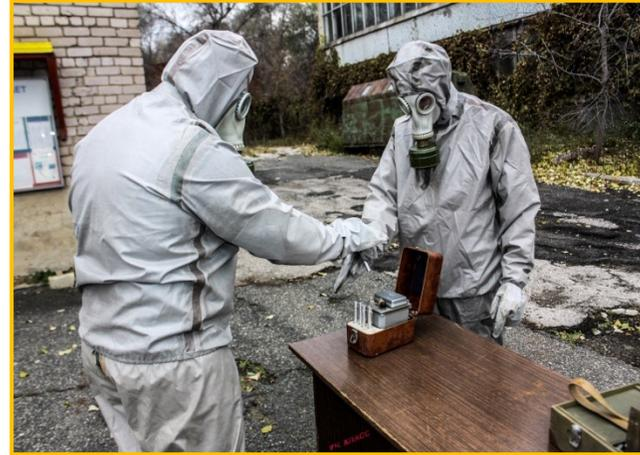
Работа с комплектом индивидуальных дозиметров ДП-22-В (ДП-24)
