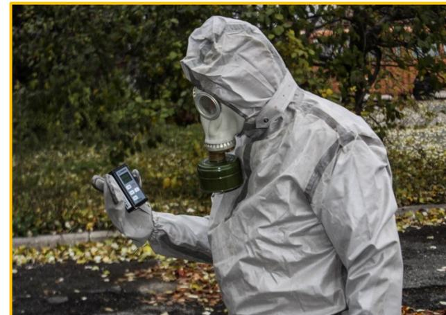
Измерение фонового гамма излучения дозиметром радиометром МКС-АТ6130,25206-13
