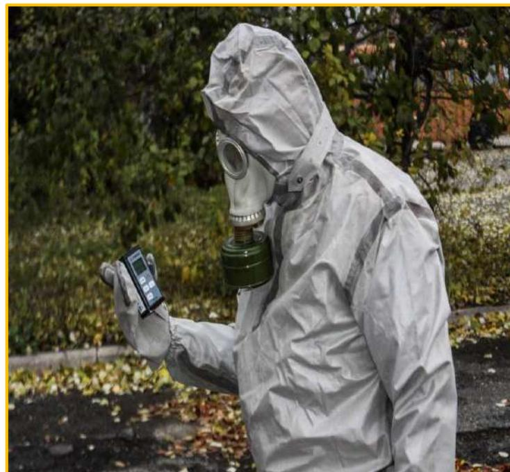
Измерение фонового гамма излучения дозиметром радиометром MKC-AT6130,25206-13
