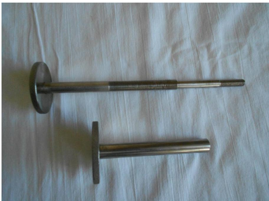
Рис. 23. Устройство для установки диафрагменной накладки в разобранном состоянии.
