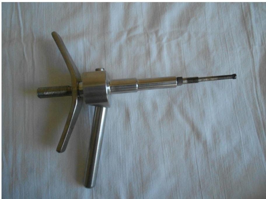
Рис. 22. Устройство для выпуска усов-зацепов
