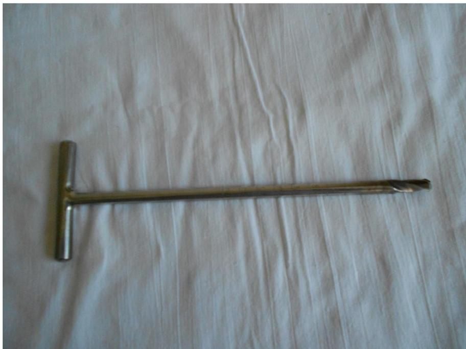
Рис. 18. Полое сверло  $d$  8,8 мм
