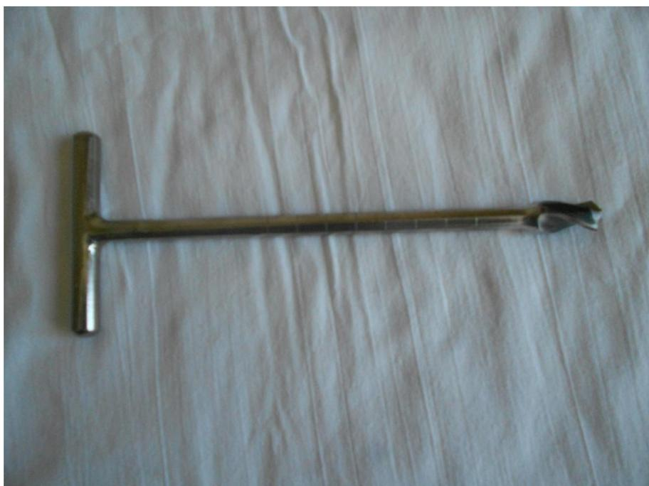
Рис. 19. Полое ручное сверло  $d$  11,7 мм
