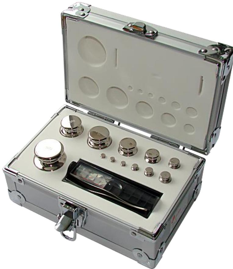
Рисунок 5. Набор гирь лабораторных М1
