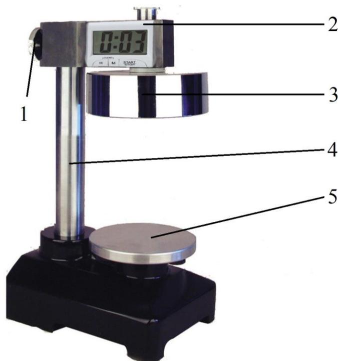
Рисунок 8. Модифицированное программируемое электронно-магнитное устройство: 1 - фиксирующий винт; 2 - блок управления магнитом; 3 - электромагнит; 4 - штанга штатива; 5 - технический столик штатива.
