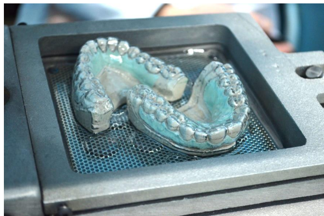
Рисунок 20 - Результат применения методики вакуумного формования с изготовлением двух моделей челюстей
