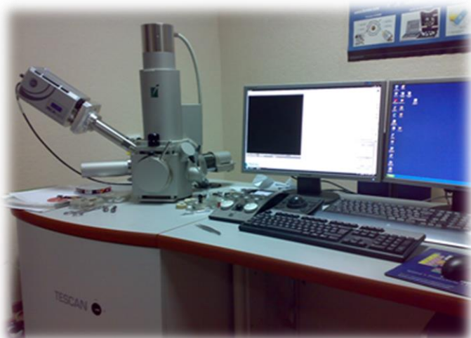
Рисунок 2.6 - Сканирующий электронный микроскоп TESCAN VEGA3 с рентгеновским детектором INCAx-act
