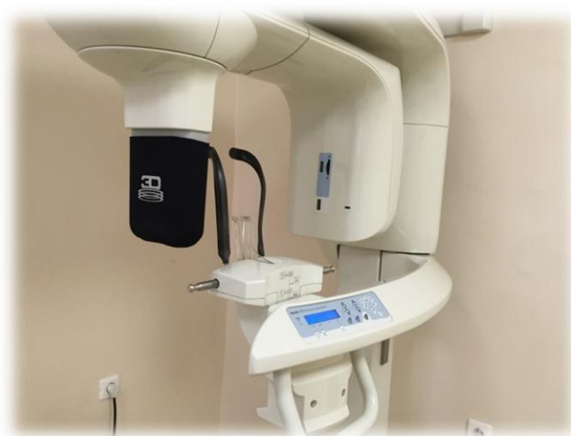
Рисунок 2.8 - Трехмерный цифровой томограф с функцией панорамного исследования Kodak 9000 3D Extraoral Imaging System
