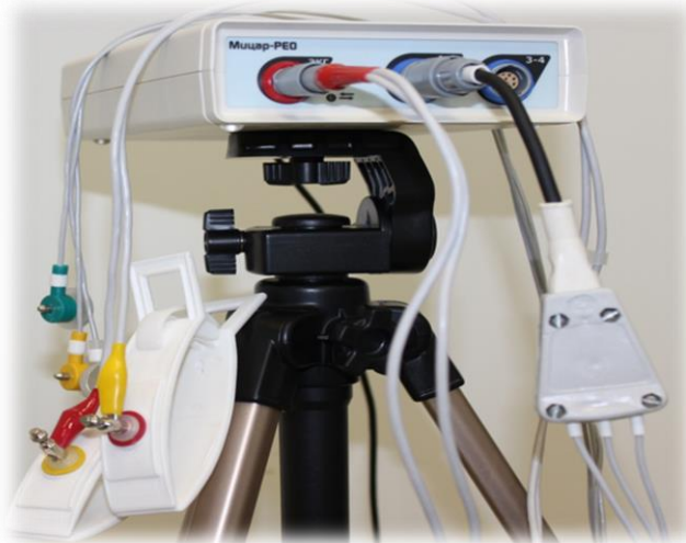
Рисунок 2.9 - Цифровой портативный реограф Мицар-РЕО на специальном штативе
