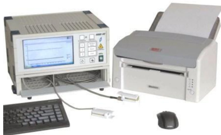
Рис. 3. Анализатор лазерной микроциркуляции крови для врача общей практики «ЛАКК-ОП».
