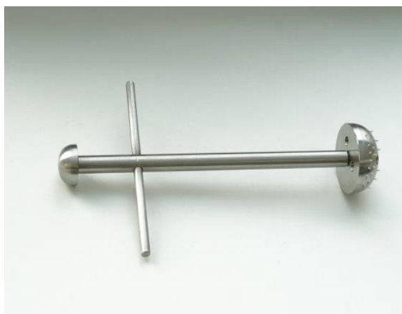
Рисунок 1. Внешний вид разработанного нами инструмента для выполнения отверстий в крыше вертлужной впадины
