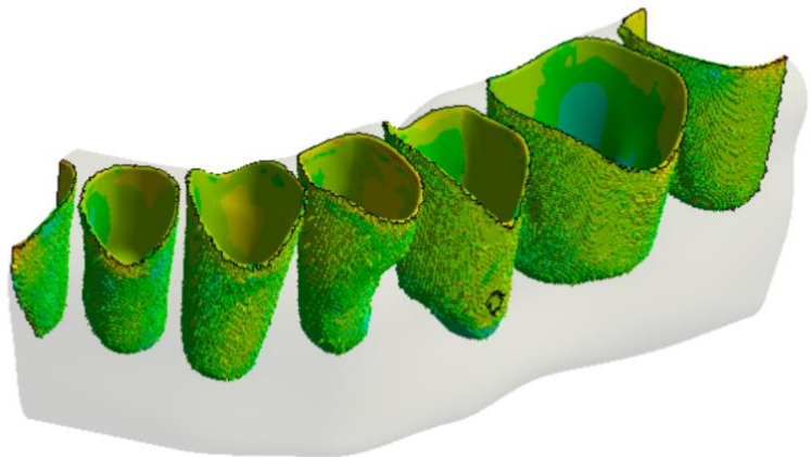
Рисунок 3.29. Эквивалентные напряжения в кортикальных пластинках при толщине 0,4 мм
