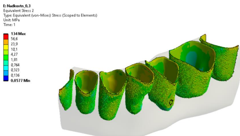
Рисунок 3.25. Эквивалентные напряжения в кортикальных пластинках при толщине 0,3 мм
