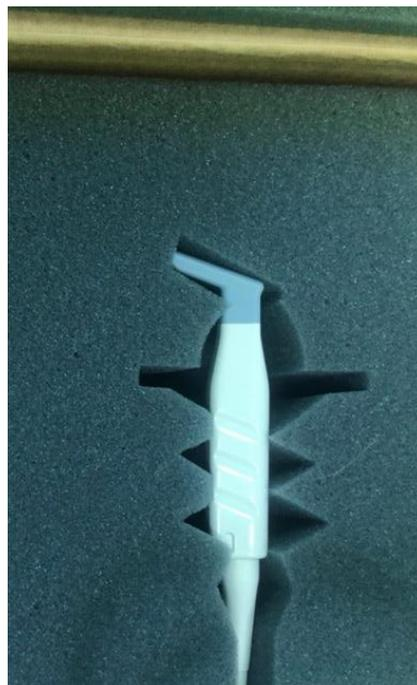
Рисунок 6. Фото Линейного датчика L 15 7 io
