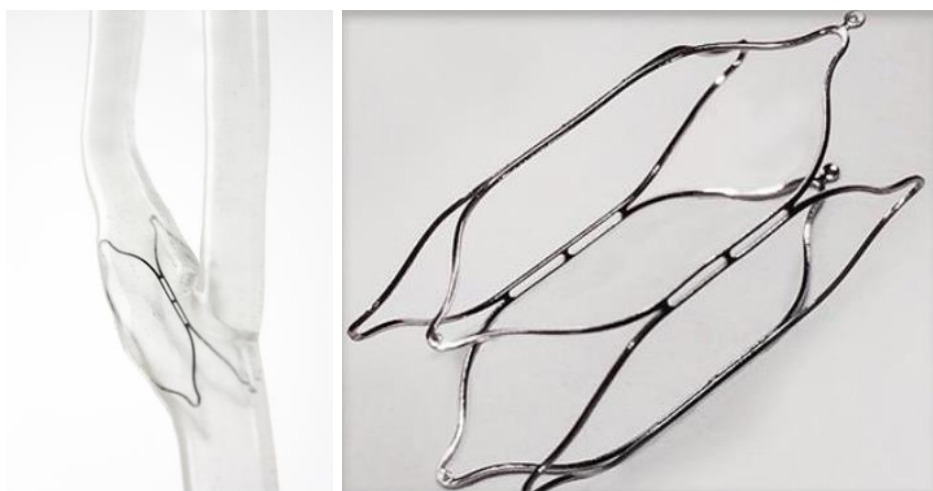
Рисунок 1.7 – внешний вид имплантируемого устройства MobiusHD в позиции каротидного синуса и на увеличении
