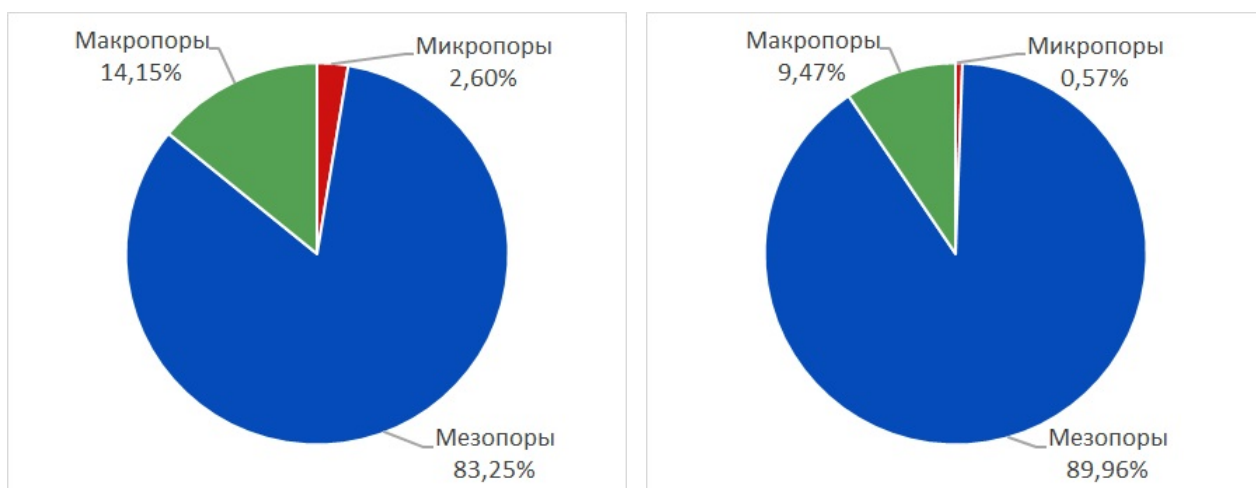
Рисунок 22 – Диаграммы распределения пор в образце молекулярно импринтированного сорбента на основе производных акриловой кислоты (образец №5): по объему (а); по площади поверхности (б).
