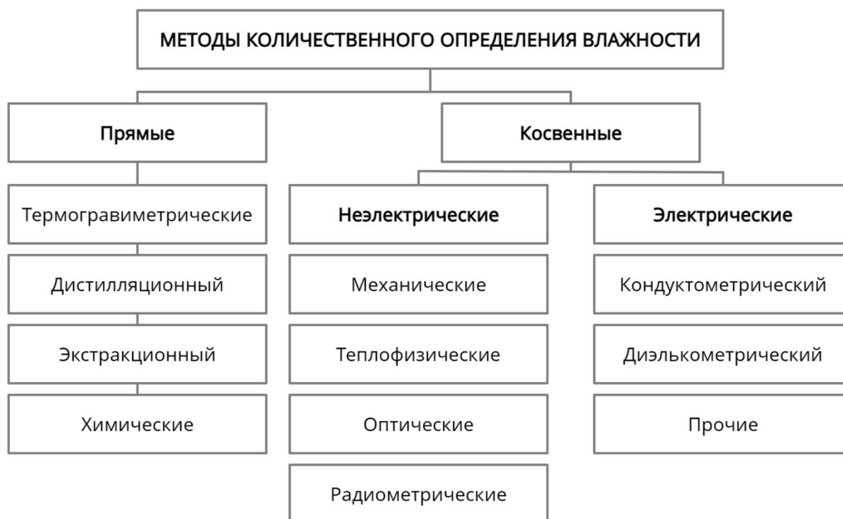
Рисунок 1 – Классификация методов определения влажности
