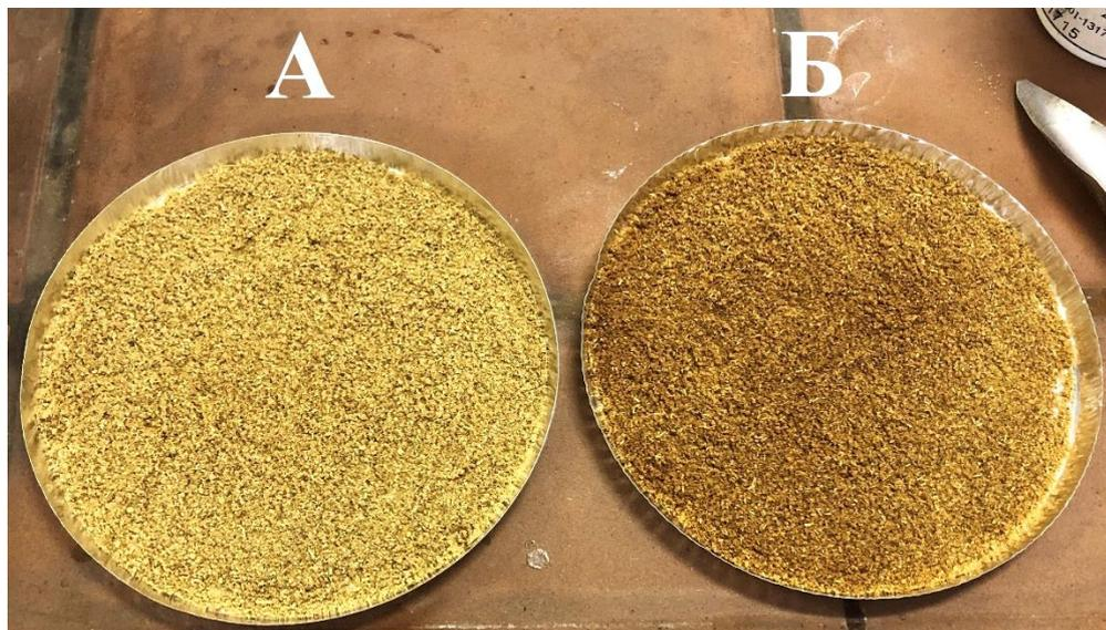
Рисунок 7 – Внешний вид отработанных проб лекарственного растительного сырья, высушенных с использованием автоматических анализаторов влажности с различными нагревательными элементами
