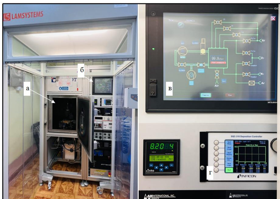
Рисунок 2.6. Внешний вид компоновки магнетронно-плазменной установки для нанесения покрытия из оксида кремния: а - камера для нанесения напыления; б - центральный пульт управления; в – схемотехническое изображение процесса нанесения покрытия; г – контроллер выполнения программы
