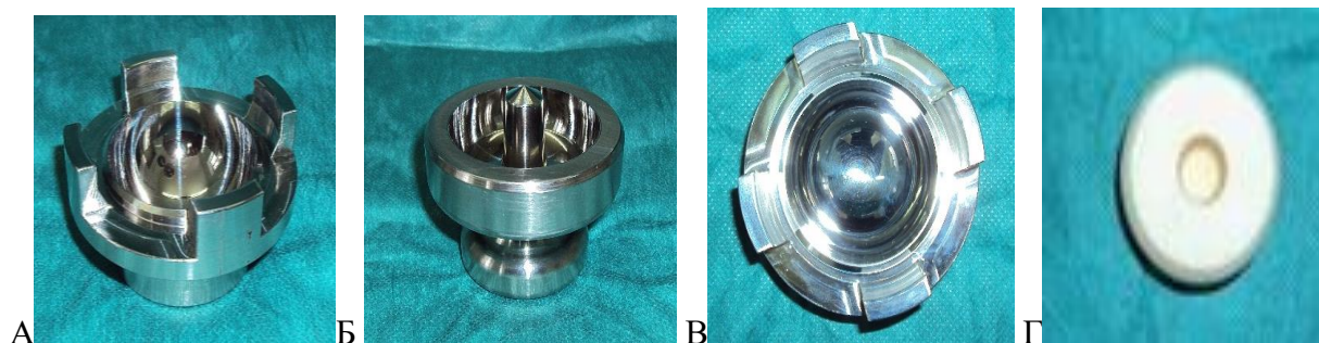
Рисунок 5. – Форма для изготовления головки монополярного спейсера тазобедренного сустава. А, Б, В – детали формы в разложенном виде; Г- изготовленная головка спейсера
