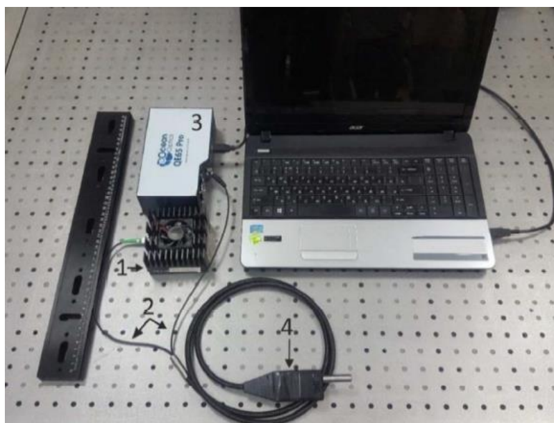
Рисунок 5 - Портативная система регистрации спектров КР: 1 – лазерный модуль, 2 – оптоволоконная система, 3 – спектрометр QE 65Pro, 4 – оптический зонд.
