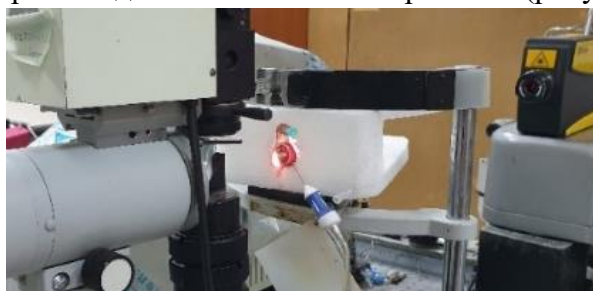
Рисунок 6. Исследование вибрации склеры при работе витреотома
