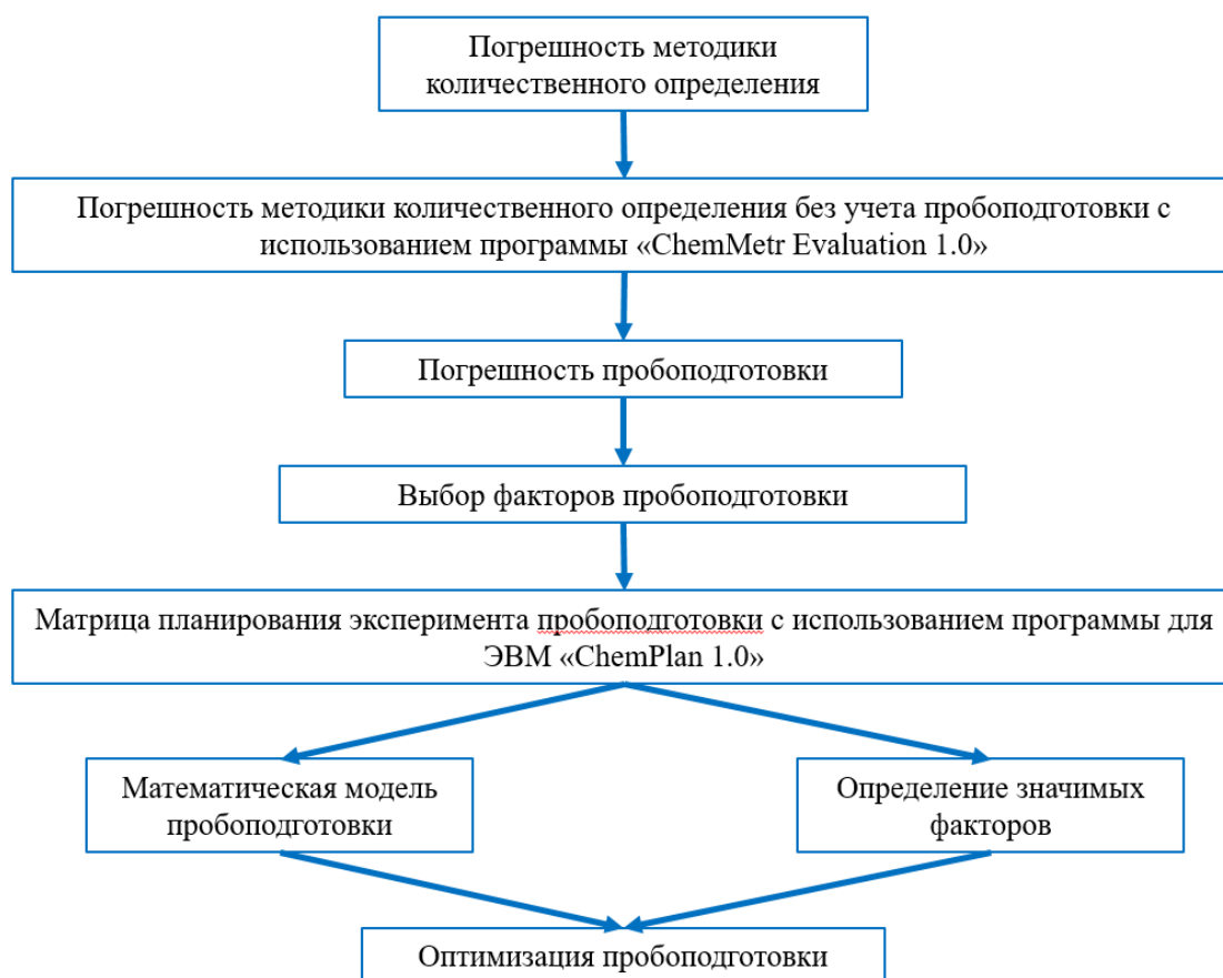
Рисунок 27 – Алгоритм планирования и оптимизации пробоподготовки методик количественного определения в контроле качества лекарственных средств и судебно-химической экспертизе.
