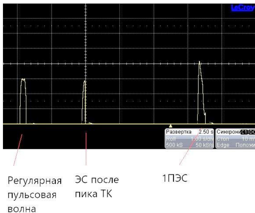
Рисунок 54 - Колебания давления внутри трубки при имитации ЭС с систолой желудочков ЭС после пика ТК и диафрагмой со стенозом 90% (возрастание давления у входа в диафрагму в 1ПЭС)
