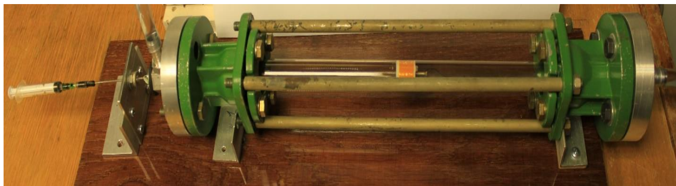
Рисунок 49 - Устройство для моделирования артериального кровообращения с установленной внутрь трубки ротаметра диафрагмой
