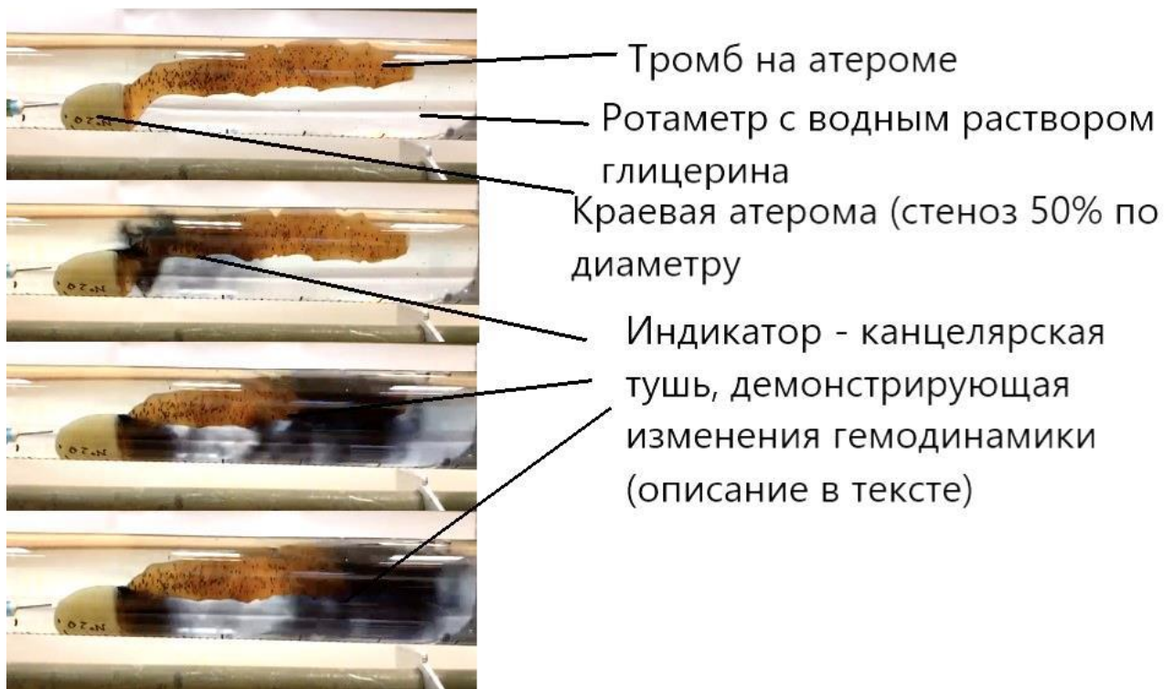
Рисунок 60 - Использование «Устройства для моделирования внутриартериального кровообращения» при имитации краевой бляшки 50%, осложненной тромбом. Турбулентный характер потока жидкости за атеромой
