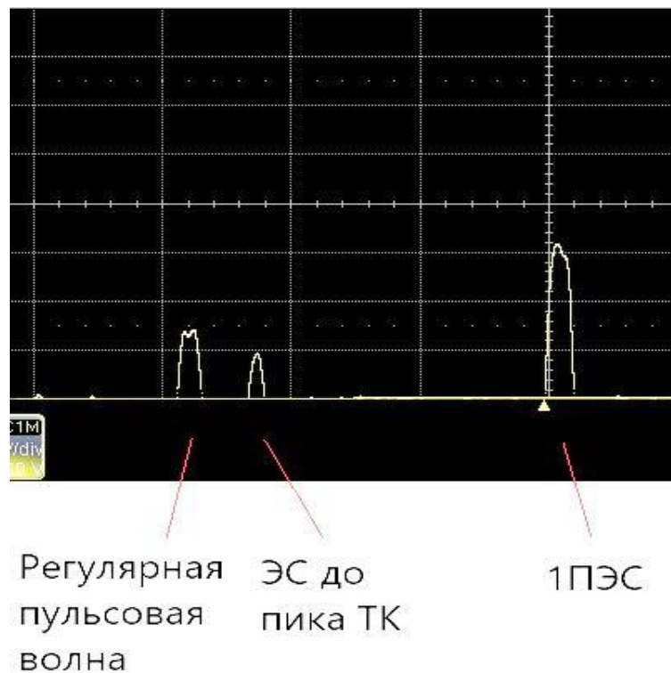
Рисунок 53 - Колебания давления внутри трубки при имитации ЭС с систолой желудочков ЭС до пика ТК и диафрагмой со стенозом 90% (возрастание давления у входа в диафрагму в 1ПЭС)
