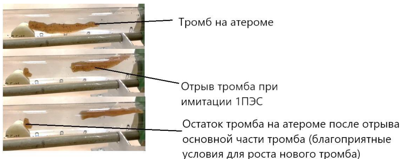
Рисунок 61 - Использование «Устройства для моделирования внутриартериального кровообращения» при имитации краевой бляшки 50%, осложненной тромбом. Момент отрыва тромба от атеромы при прохождении волны 1ПЭС
