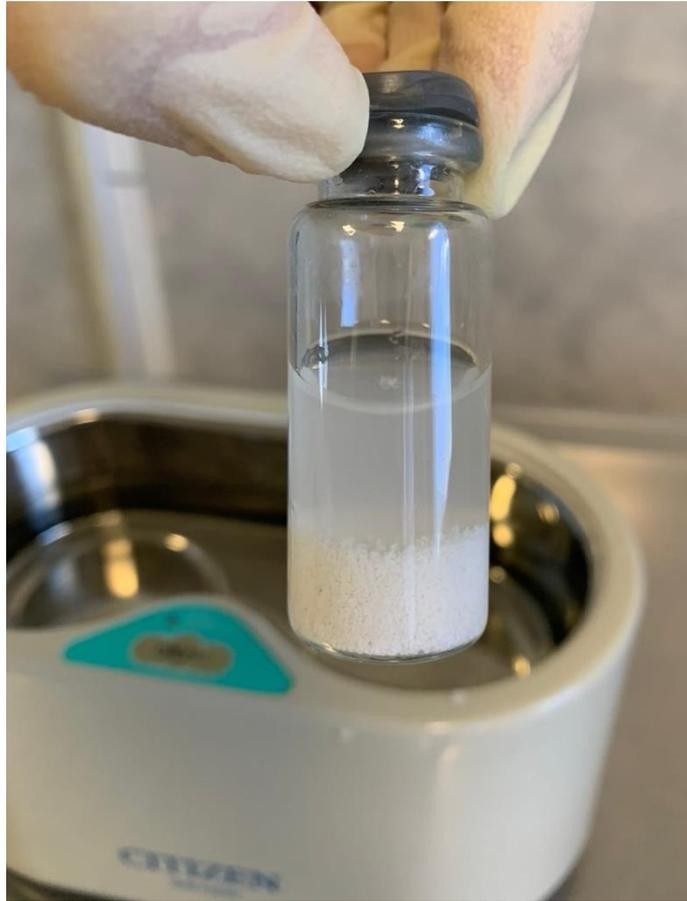
Рисунок 36 – Фракция Компонента 1, подготовленная разработанным нами способом дегазации и экстракции пыли
