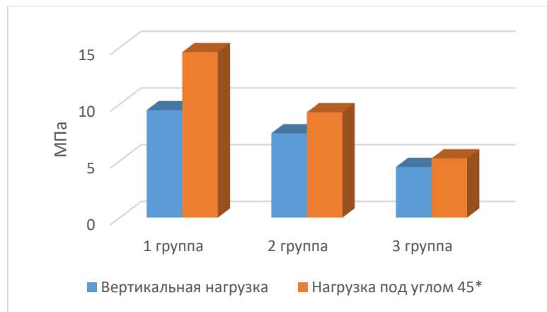
Рисунок 37. Результаты расчета НДС максимальные напряжений в сечении в различных ортопедических конструкциях при вертикальной нагрузке и нагрузке под углом 45°, МПа
