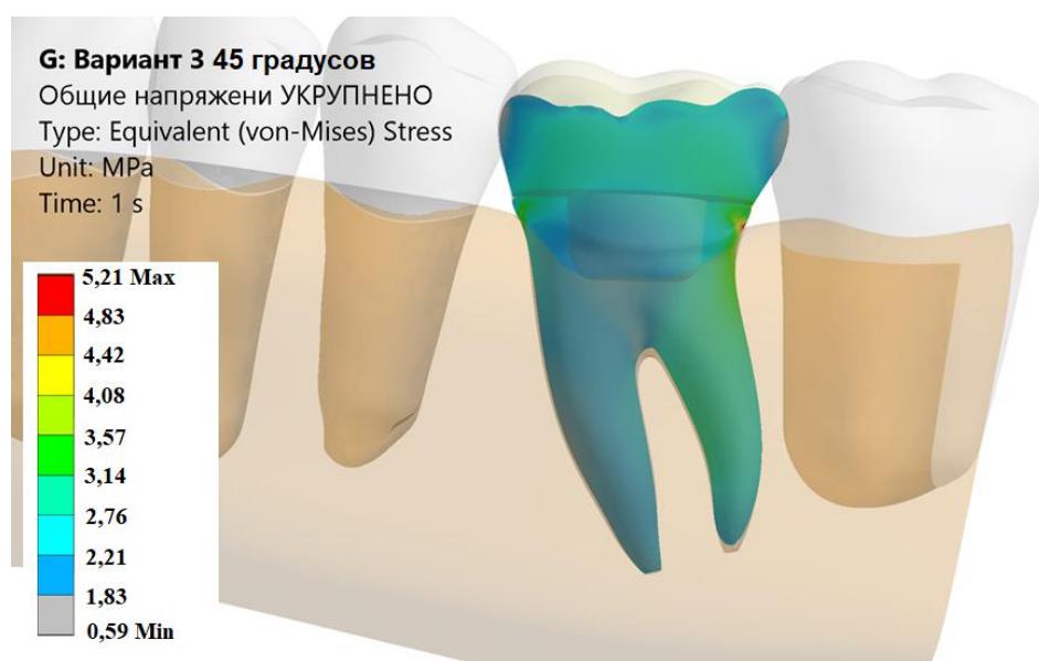
Рисунок 33. Напряженно-деформированное состояние в продольном сечении зуба (3 группа) при нагрузке, направленной под углом 45^\circ к оси зуба
