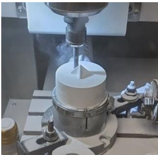
Рисунок 30 - Этап производства нового эндопротеза на базе Центра серийного производства СамГМУ: механическая обработка изделия.
