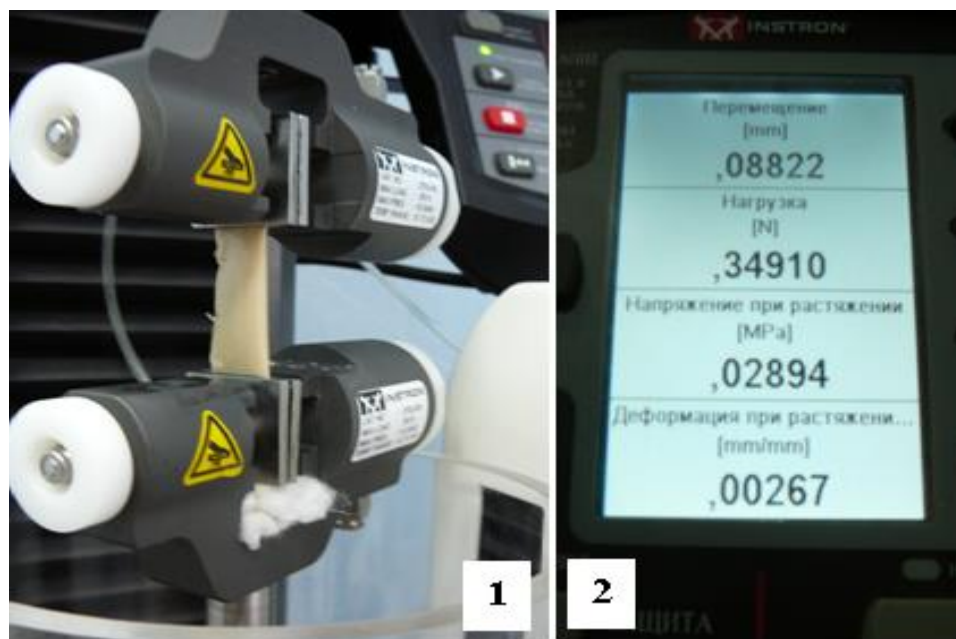
Рисунок 12 – Проведение экспериментального исследования на разрывной машине: 1 - образец ксеноперикарда в зажимах разрывной машины INSTRON – 5944 BIO PULS; 2 - монитор разрывной машины с показателями разрывной нагрузки.
