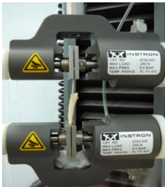
Рисунок 16 – Образец ахиллова сухожилия, прошитый нитью в зажимах разрывной машины INSTRON – 5944 BIO PULS. Исследование механических свойств на прорезывание шовным материалом.
