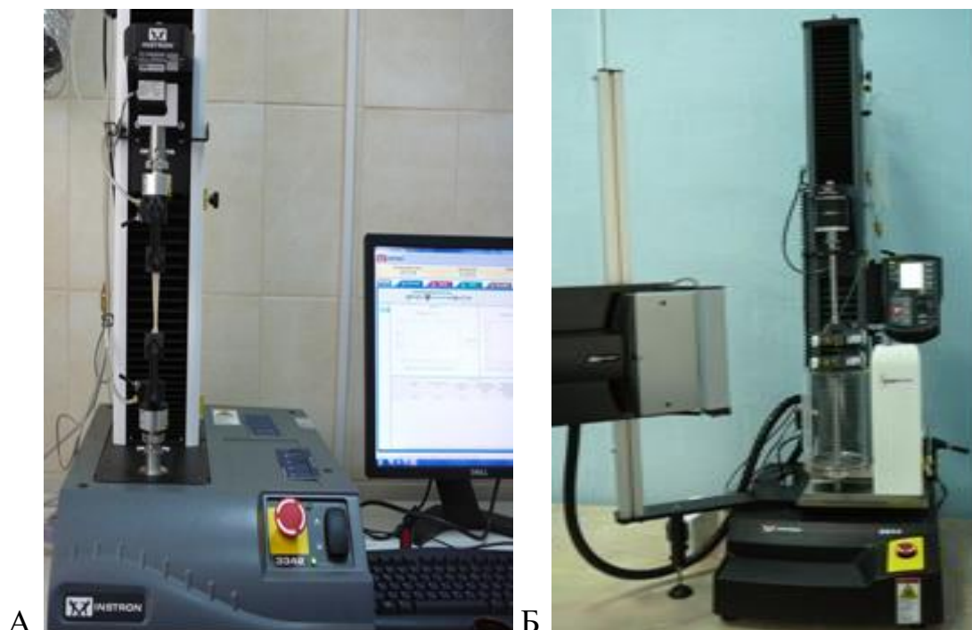
Рисунок 6 - Разрывные машины: А - INSTRON-3342; Б - INSTRON-5944 BIO PULS (Б (INSTRON, США) с программным обеспечением
