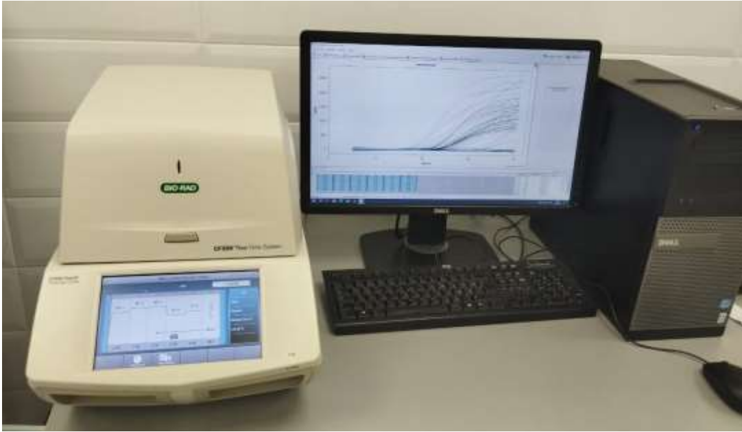
Рисунок 13 — ДНК-амплификатор в реальном времени CFX Opus 96 Bio-Rad использованный для ПЦР-диагностики в НИИ медицинской микологии им. П.Н. Кашкина СЗГМУ им. И.И. Мечникова
