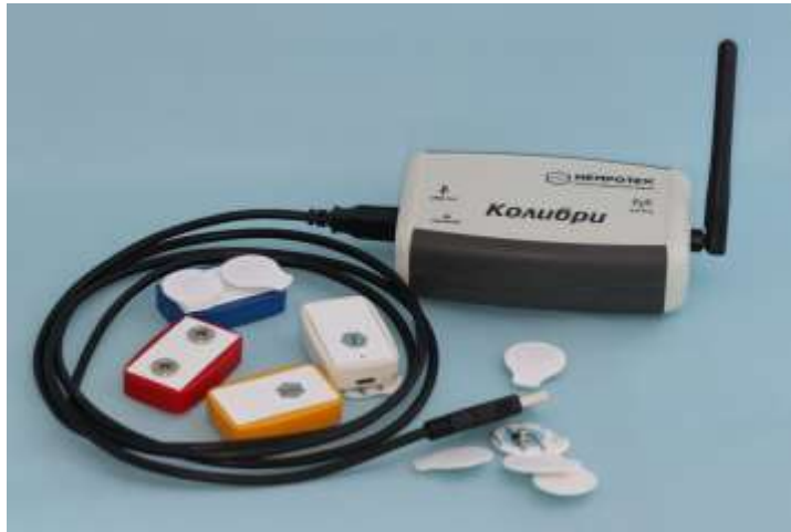
Рисунок 15 — Электромиограф «Колibri»: основной блок с антенной (модуль приёма-передачи (Bluetooth)), четыре беспроводных биполярных датчика и одноразовые электроды
