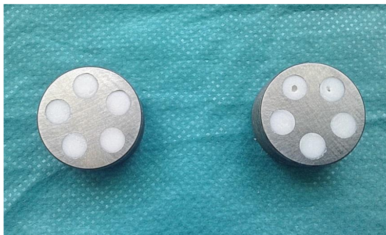
Рисунок 7 – Макрополости в застывших образцах акрилового костного цемента Synicem 1 ® в пресс-форме справа
