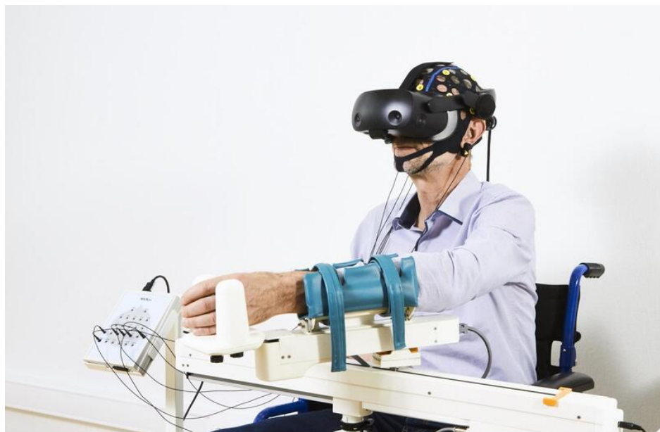
Рисунок 7. Роботизированный реабилитационный нейротренажер VIBRAINT RehUp с БОС (Рисунок из руководства к аппарату)
